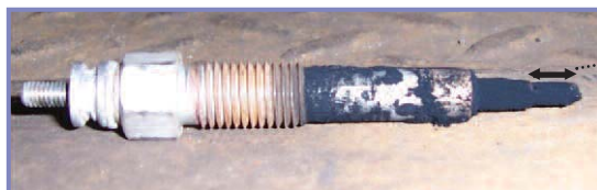
Figur 5 viser en normalt slidt spids
