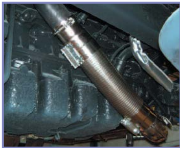
Figur 18 - Typisk flexrør, som beskytter mod vibrationer
