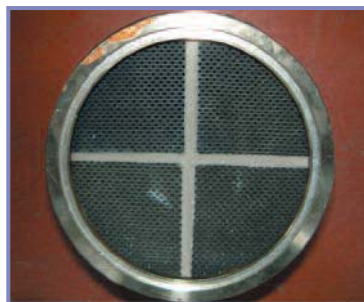
Figur 17 - Udgangsoverflade på et brugt filter
