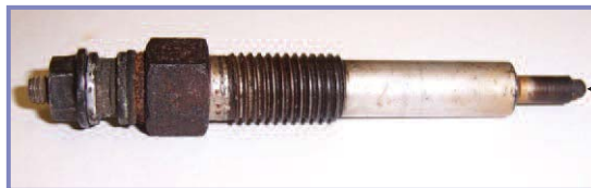
Figur 6 viser et nedslidt gløderør
