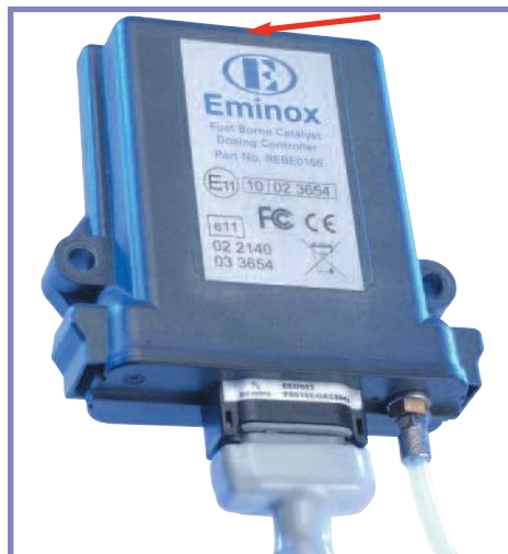
Figur 10 - placering af reedafbryder
